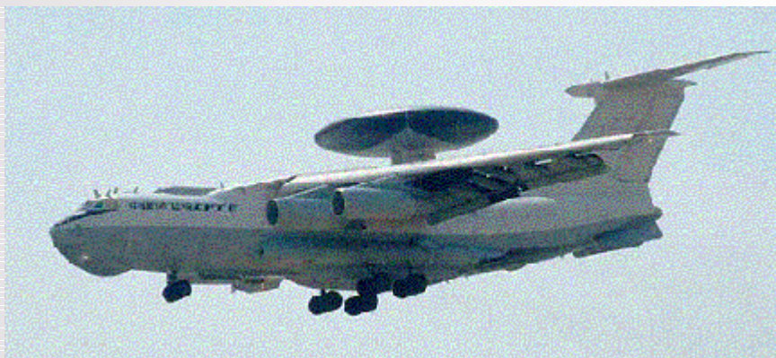
Рис. Самолет радиолокационного дозора и наведения. Оснащен радиолокационным комплексом, скрытом в неподвижном обтекателе.
